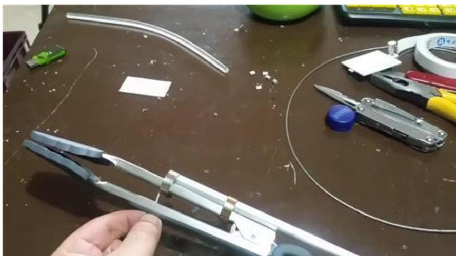
Ajustar alambre a la pinza. Pinza metálica para levantar objetos.
