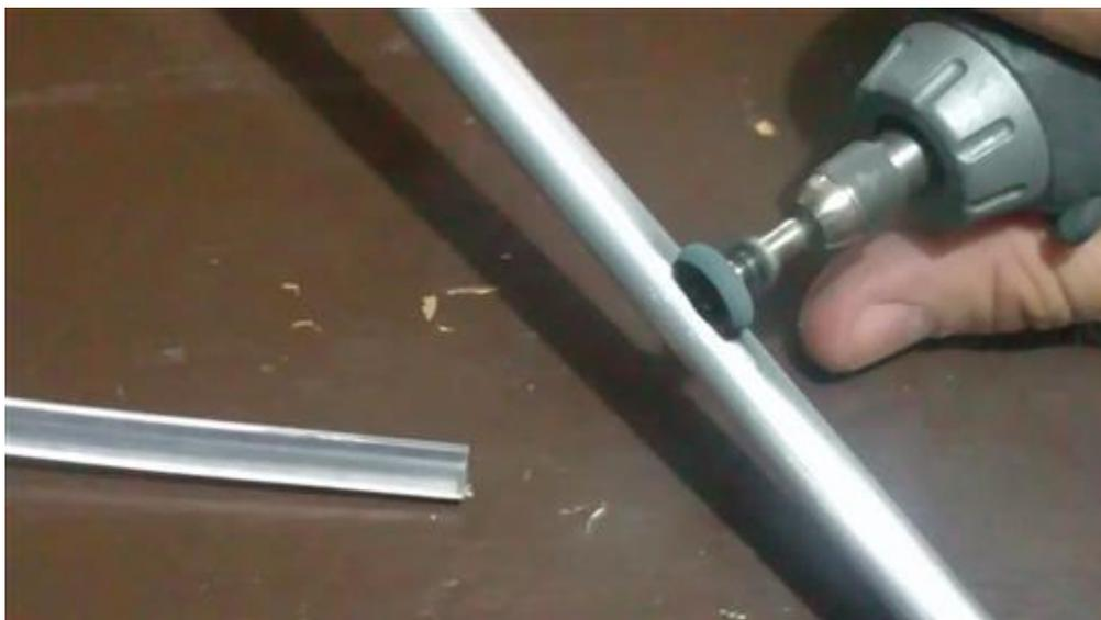
Abrir hueco para poder pasar por ahí el alambre. Pinza metálica para levantar objetos
