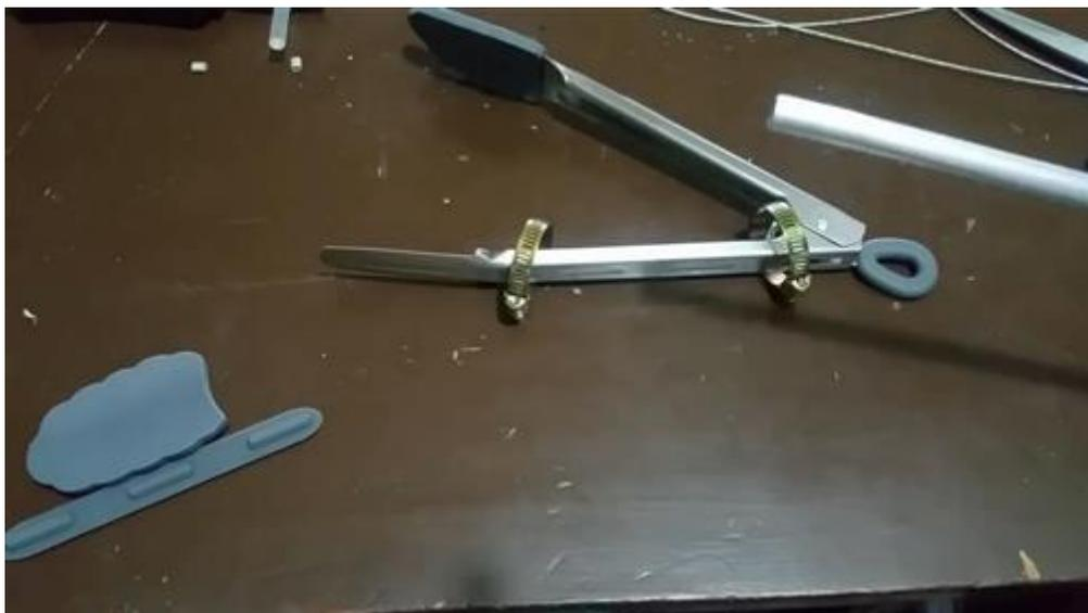
Pinza metálica con silicona para el agarre. Pinza metálica para levantar objetos
