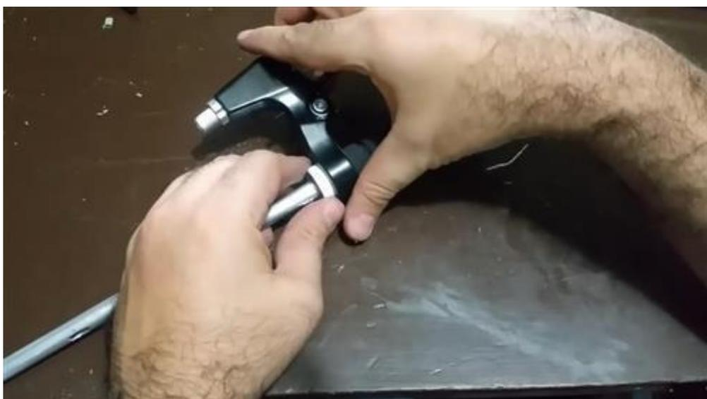
Ajustar el freno de bicicleta al tubo de pvc. Pinza metálica para levantar objetos.
