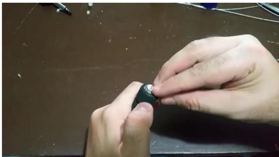
Pegamos el imán de neodimio en un extremo. Pinza metálica para levantar objetos.
